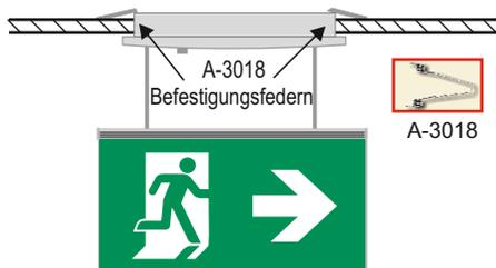
Deckeneinbau in abgehängter Decke
